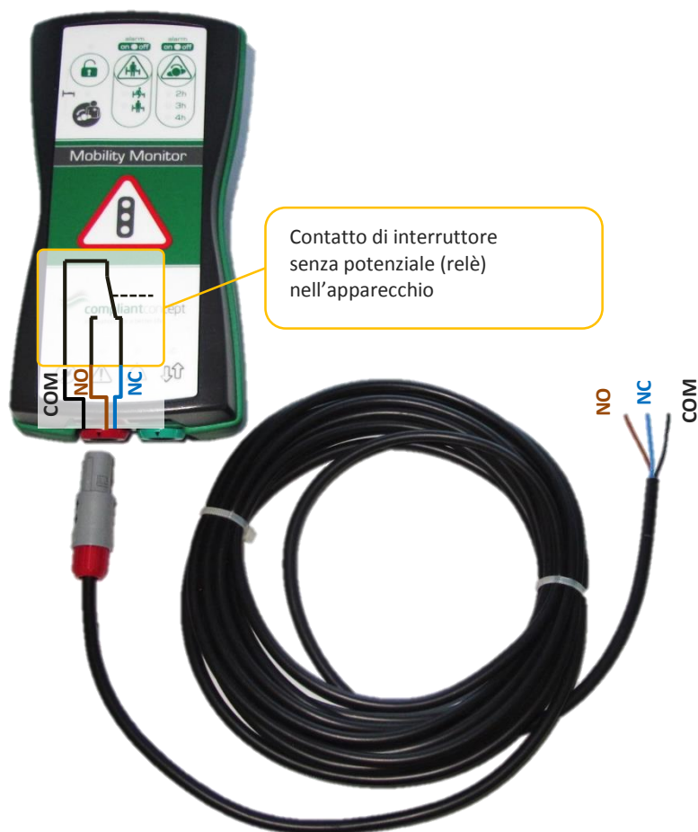
Figura 2: rappresentazione schematica del relè nell'unità di comando
