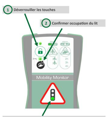
Le feu vert s'arrête de clignoter et reste continuellement allumé: l'alerte de sortie de lit est active (à condition que l'alerte de sortie de lit soit active).
