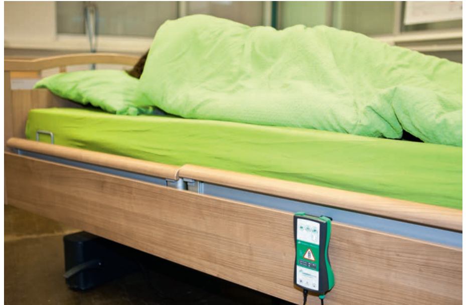
Unter der Matratze ist eine Messeinheit fixiert, die sowohl mit dem Displaygerät am Bettrand als auch mit einer Lichtrufanlage verbunden ist.
