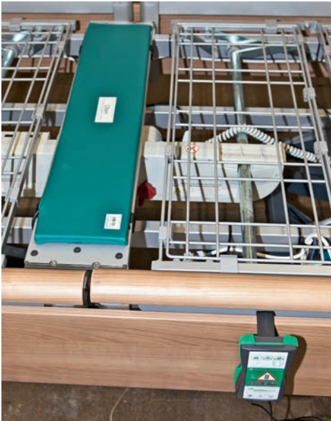
Unter der Matratze ist eine Messeinheit fixiert, die sowohl mit dem Displaygerät am Bettrand als auch mit einer Lichtrufanlage verbunden ist.
