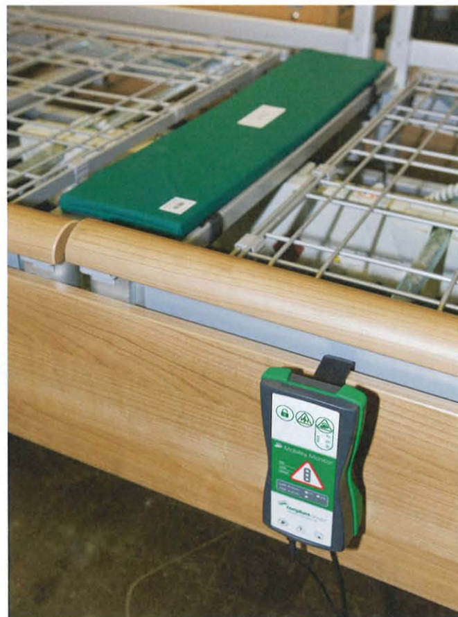
Der Sensor unter der Matratze misst berührungslos feinste Bewegungen und sendet die Daten auf das Display am Bett.
