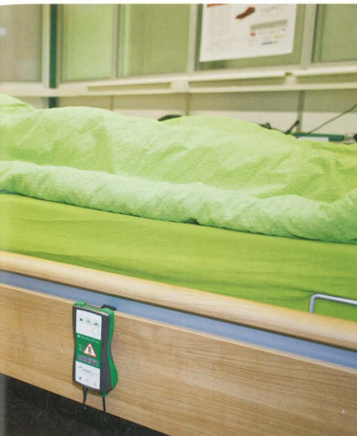
Bewegungsmelder am Bett: Das System erkennt, ob die bettlägerige Person ihre Druckstellen genügend entlastet.
