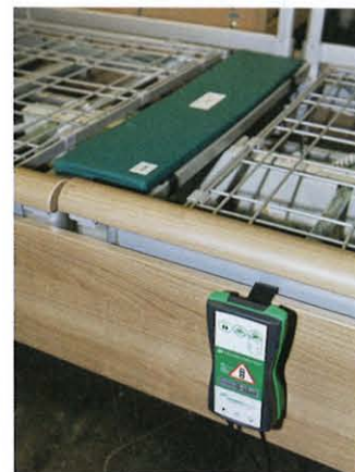
Die Sensoreinheit unter der Matratze misst berührungslos feinste Bewegungen der bettlägerigen Menschen und sendet die Daten auf das Display am Bett.
