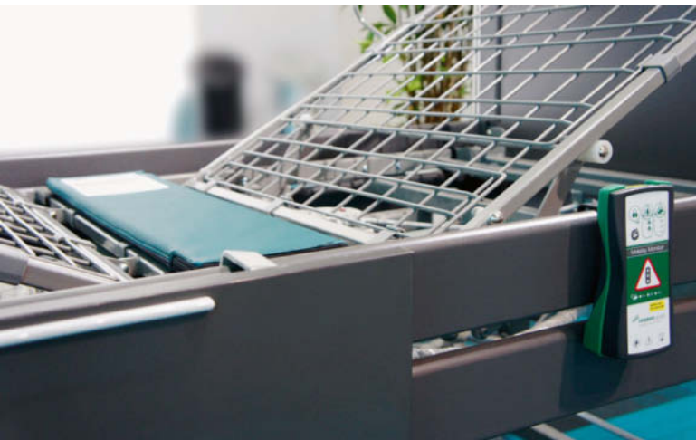
Die Messeinheit des Mobility Monitors wird unter der Matratze fixiert und mit dem Bediengerät verbunden.
